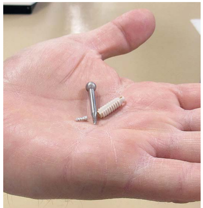
Viti ossee in magnesio e titanio, e prototipo di impianto in PEEK.
