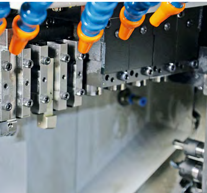
Das Modulkonzept wird mit dem Linearschlitten der Swiss DT 26 realisiert.
