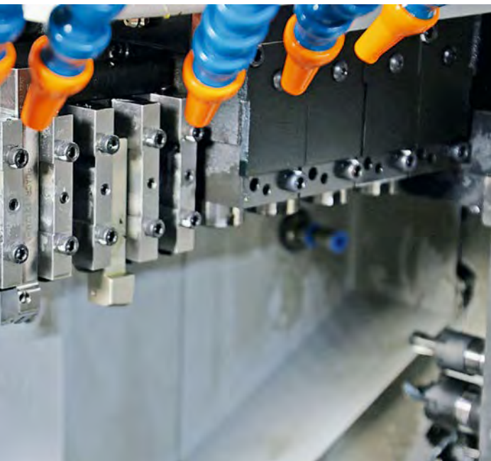
Diseño modular gracias a los peines portaherramientas de Swiss DT 26.
